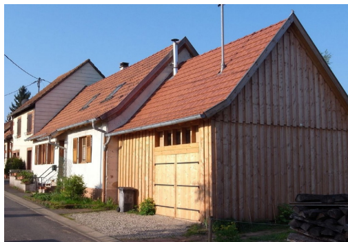
Bardages en bois : pin sylvestre, chêne, châtaignier
