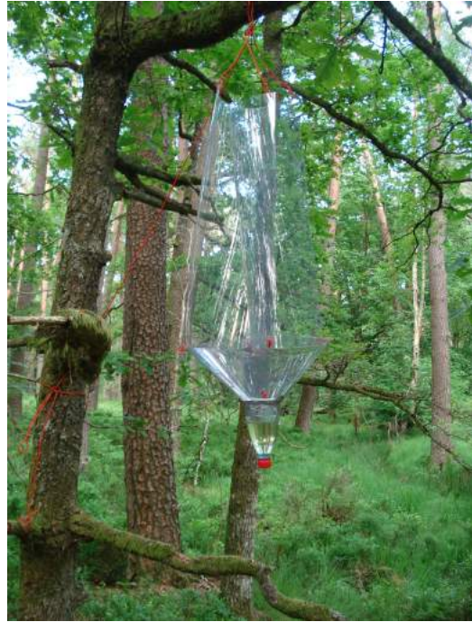
Modèle : piège à interception, sans attractif placé à hauteur d'homme
