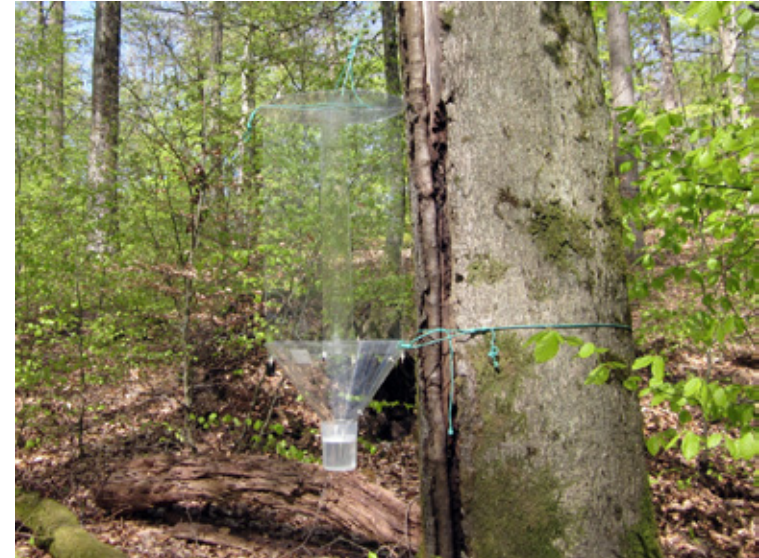
Photo 1 : Piège-vitre Polytrap™ disposé contre un tronc de Hêtre carié.
