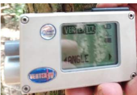
Figure 26 : Utilisation du mode Angle du Vertex afin de mesurer la distance de l'arbre par rapport au centre (Source : A. Vichard)
